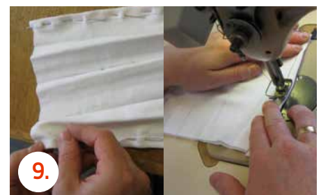
9. Kantenverstärkungen feststecken und vernähen
